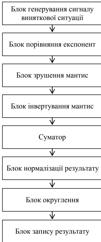
Рис. 2. Структурна схема суматора дійсних чисел на FPGA
