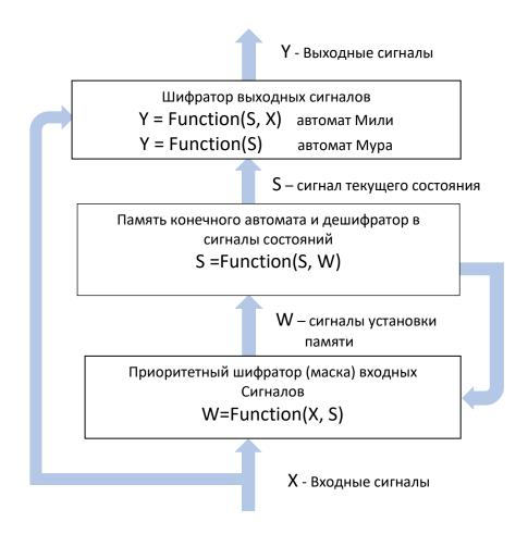
6. Ели вы проектируете конечный автомат с организацией памяти в виде линейки триггеров, то необходимо для каждого состояния определить уникальную комбинацию битов на выходах этих триггеров. Для этого используется таблица кодирования состояний автомата. Основными особенностями выбора количества (М) триггеров и комбинаций битов для кода каждого состояния являются следующие правила:
